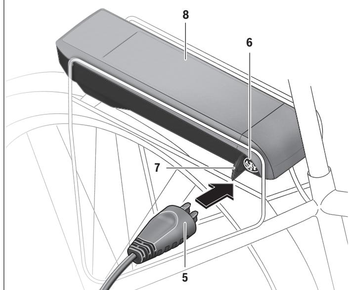
Apague el acumulador. Limpie la cubierta del conector hembra para carga **7**. Ponga especial cuidado de no ensuciar el conector hembra para carga ni los contactos con arena o tierra, p.ej. Levante la cubierta del conector hembra para carga **7** y conecte el conector macho del cargador **5** al conector hembra para carga **6**.
