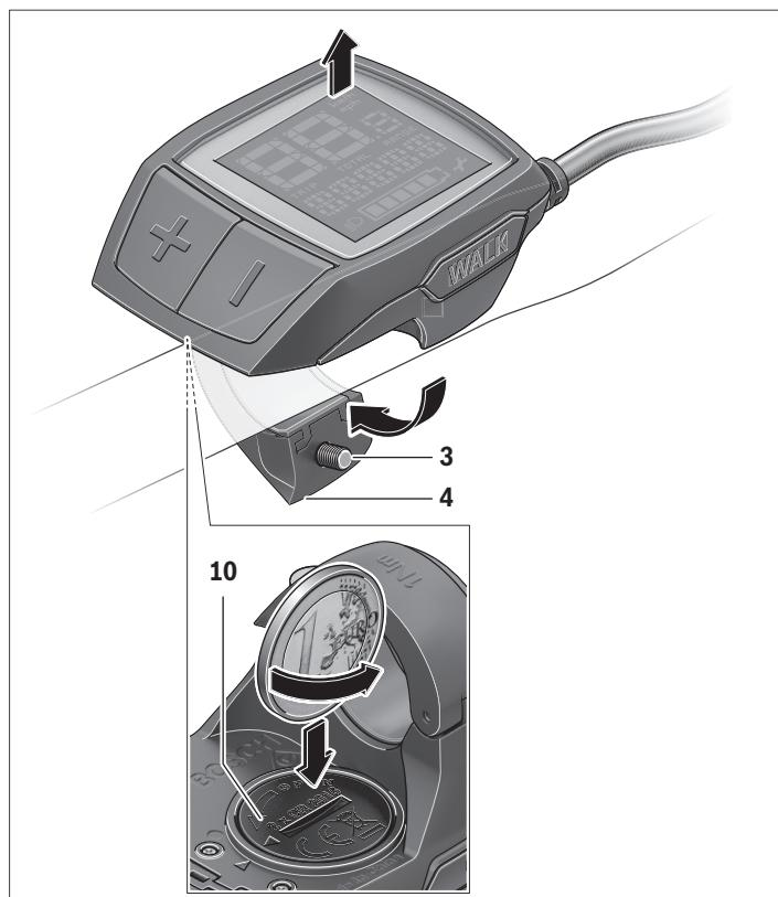
Lorsque l'ordinateur de bord affiche « **LOW BAT** » sur son écran, retirez-le du guidon. Pour ce faire, retirez les vis de fixation **3** de l'ordinateur de bord. Ouvrez le couvercle du compartiment à piles **10** avec une pièce de monnaie de taille adaptée, retirez les piles usagées et insérez des piles neuves du type CR 2016. Vous pouvez vous procurer les piles recommandées par Bosch auprès de votre revendeur spécialisé.
