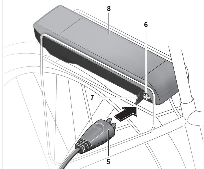
Eteignez l'acco. Nettoyez le couvercle de la prise de charge **7**. Evitez tout encrassement de la prise de charge et des contacts, parex. par du sable ou de la terre. Soulevez le couvercle de la prise de charge **7** et connectez la fiche de charge **5** à la prise de charge **6**.
